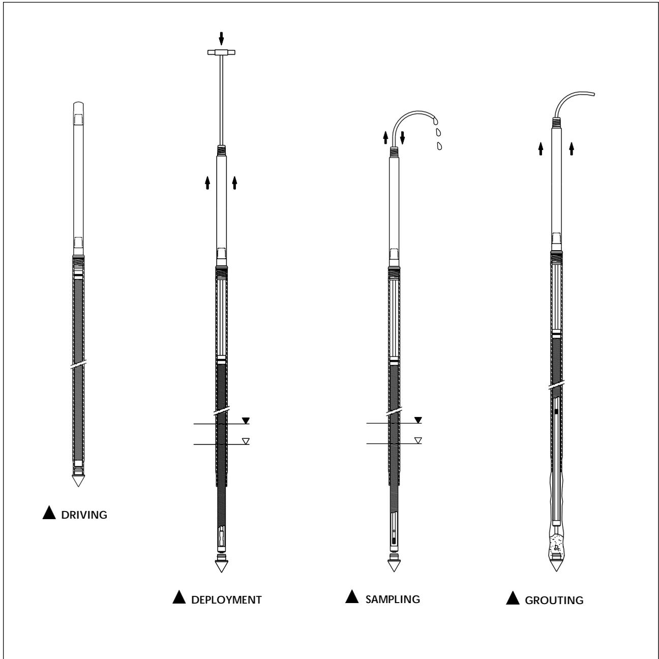
GEOPROBE SCREEN POINT 15 / SCREEN POINT 16 GROUNDWATER SAMPLERS
